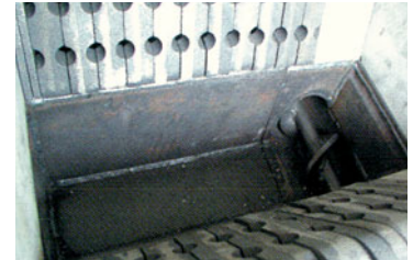
Unterschubbrennkammer (USF-S) Feuerungsretorte aus 15 mm starker Stahlkonstruktion mit automatischer Ascheustragung.
