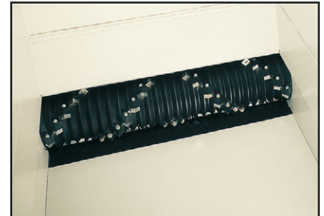
Zerkleinerungsrotor mit Messern und Gegenmessern sowie hydraulischem Schubkasten
