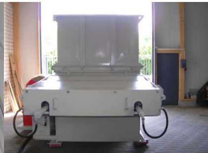
Ansicht von hinten: Fülltrichter und Hydraulikzylinder
