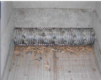
Sicht in den Trichter: Mit den Schneidmessern bestückter Rotor
